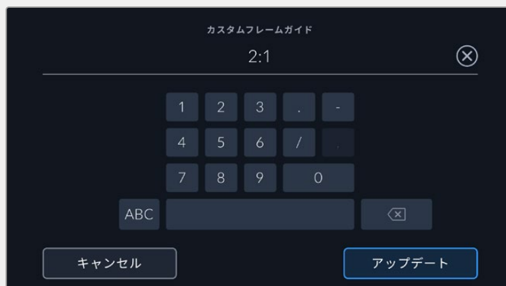
「カスタムフレームガイド」画面でテンキーパッドを使用して、フレームガイドの新しいアスペクトレシオを入力
