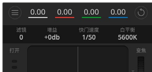
将鼠标指针停留在增益、快门速度栏以及白平衡指示器上时, 会出现箭头图标, 点击箭头图标可调整相应设置
