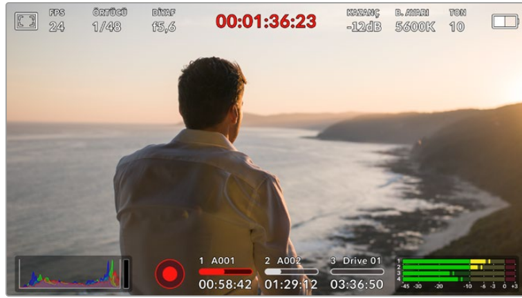
URSA Broadcast G2'nin dokunmatik LCD ekranı, kapsamlı bir denetim merkezi ekranına sahiptir ve kameranızın en sık kullanılan ayarlarına kolay erişim sağlar.
