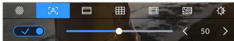
LCDモニターオプションでフォーカスアシストアイコンをタップして、URSA Broadcast G2のフォーカスアシスト設定にアクセス
