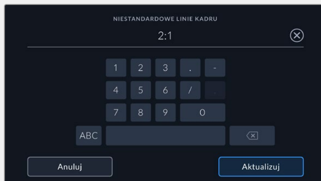
Użyj klawiatury numerycznej na ekranie Niestandardowe linie kadru , aby wprowadzić nowy współczynnik linii kadru
