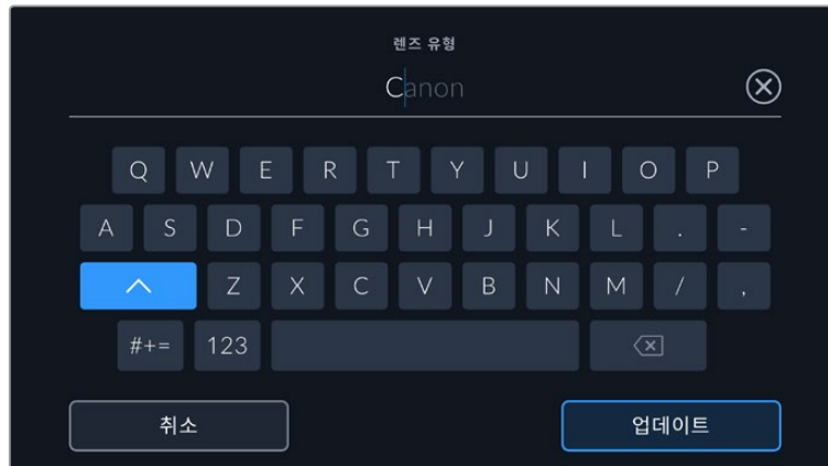
렌즈 데이터가 자동으로 제공되지 않을 시 터치 키보드를 사용해 입력할 수 있습니다.
