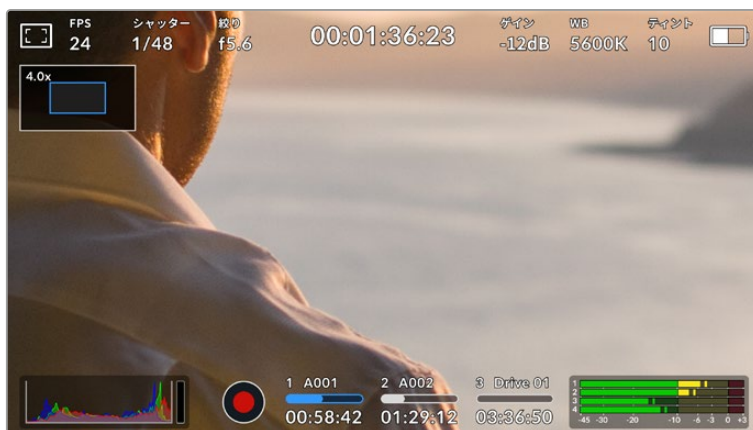
ズームインしている際、LCDタッチスクリーン左上のインジケータは、見ているイメージの領域を表示。メニューホイール (MENU) を使用するか、画面で指をドラッグすると、イメージを動かすことが可能。
