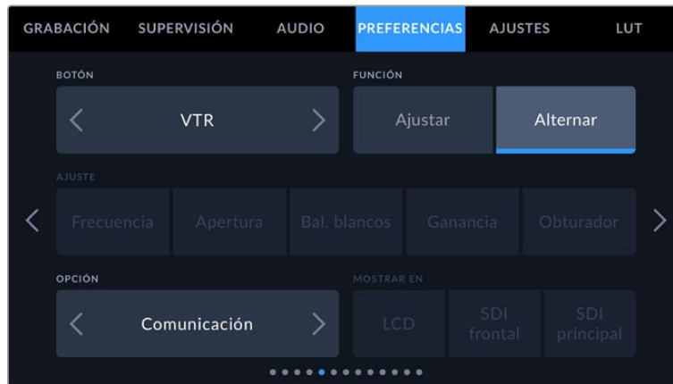
Configuración del botón VTR para comunicarse con otros operadores.
