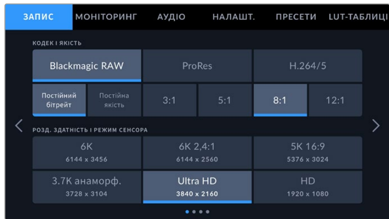
Налаштування Blackmagic RAW, вибрані за замовчуванням на вкладці «ЗАПИС»
