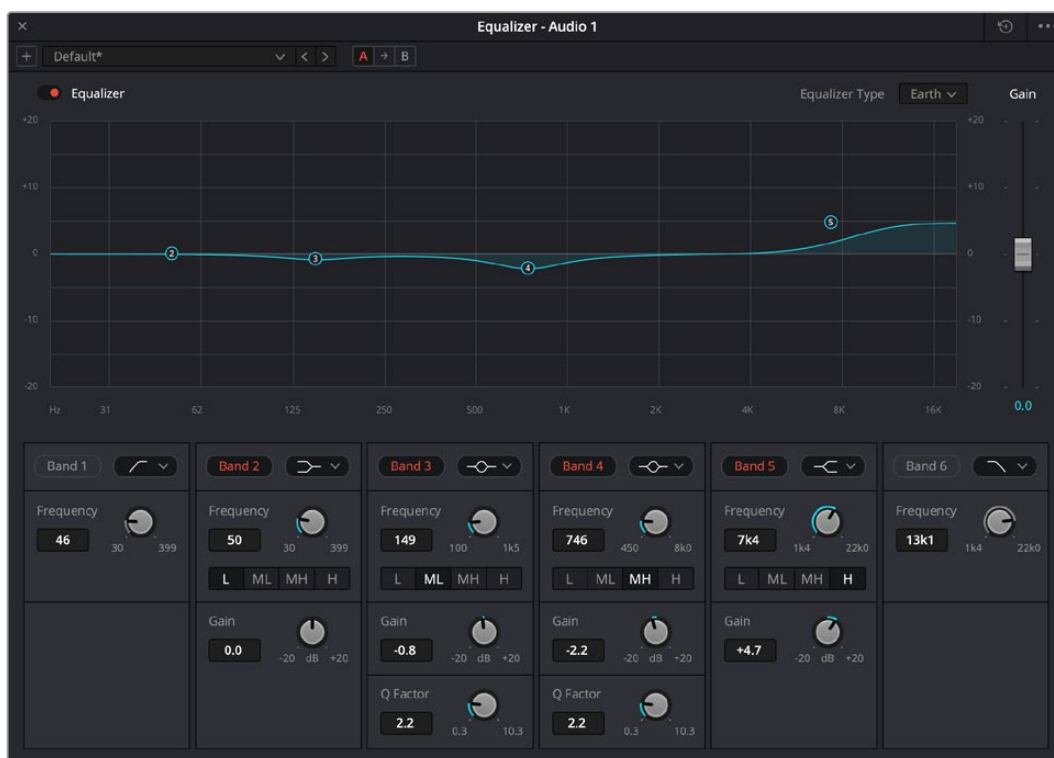
Sekcja korektora w panelu miksera wskazująca, że krzywa korektora została zastosowana do ścieżki pierwszej
