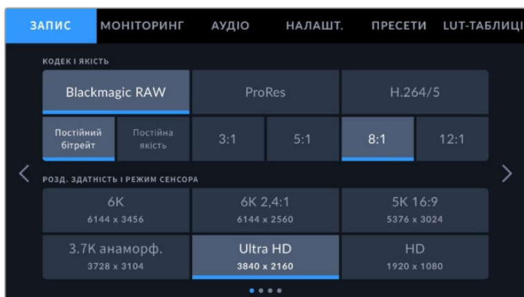
Екранна панель інструментів камери містить вкладки «ЗАПИС», «МОНІТОРИНГ», «АУДІО», «НАЛАШТ.», «ПРЕСЕТИ» та «LUT-ТАБЛИЦІ»
