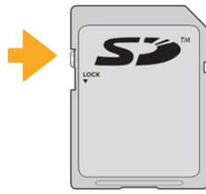
上下拨动锁定开关可锁定或解锁SD卡
