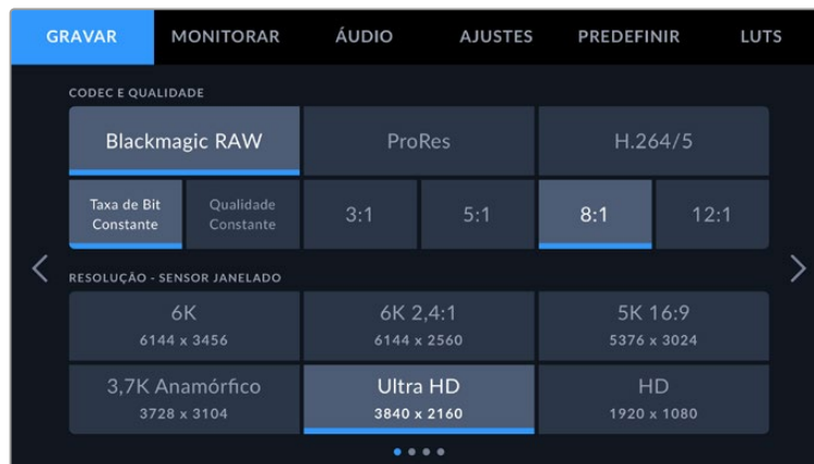
Configurações Blackmagic RAW padrão na aba Gravar.
