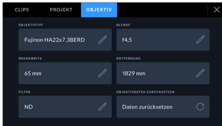
Der OBJEKT-Tab mit automatisch generierten Daten eines Fujinon-Objektivs
