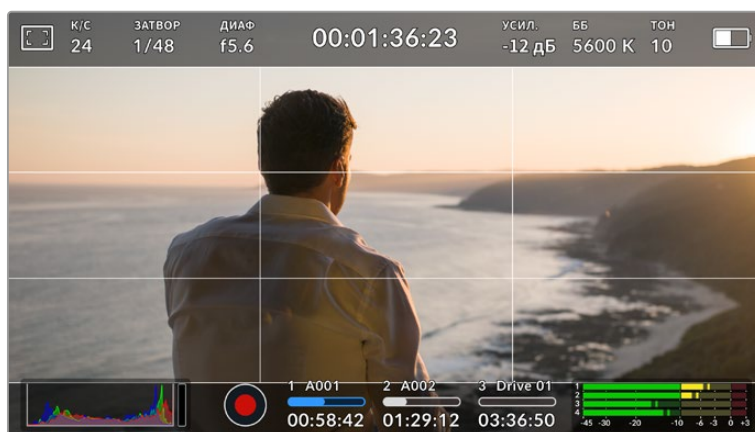
Сетка по правилу третей автоматически масштабируется в соответствии с пропорциями кадра
