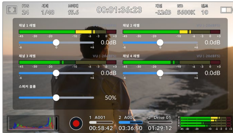
URSA Broadcast G2의 LCD 터치스크린에 있는 오디오 미터를 눌러 볼륨과 헤드셋 또는 스피커 설정에 쉽게 접속할 수 있습니다.
