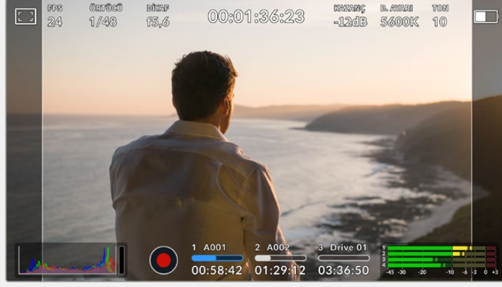
14:9 çerçeve kılavuzları etkinleştirilmiş olarak URSA Broadcast G2 dokunmatik LCD ekranı
