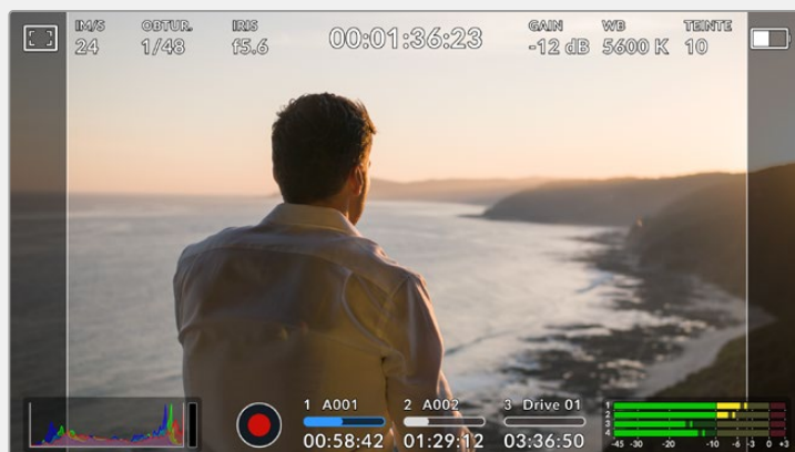
Écran tactile de la URSA Broadcast G2 sur lequel le repère de cadrage 14:9 est activé.
