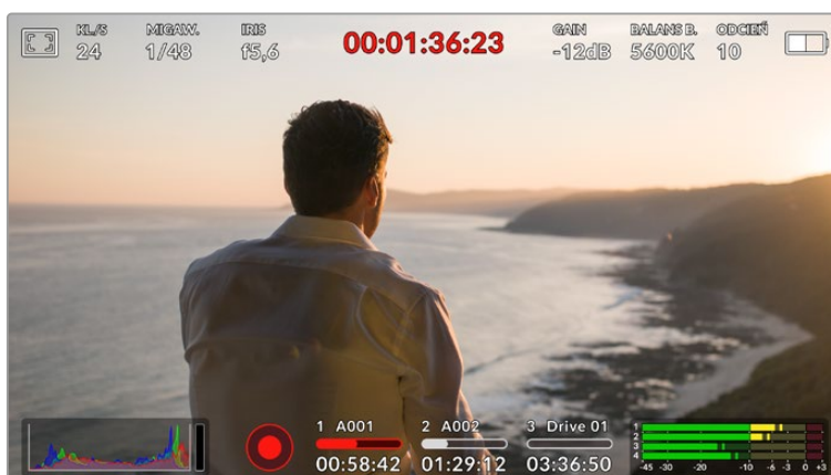
Ekran dotykowy LCD URSA Broadcast G2 posiada kompleksowy wyświetlacz przezierny i zapewnia łatwy dostęp do najczęściej używanych ustawień kamery
