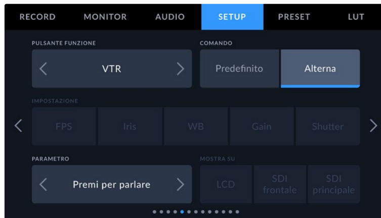
Il pulsante VTR dell'obiettivo B4 programmato con il parametro Premi per parlare
