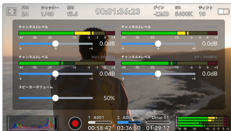
URSA Broadcast G2のLCDタッチスクリーンでオーディオメーターをタップし、ボリュームおよびヘッドセット/スピーカー設定に簡単にアクセス
