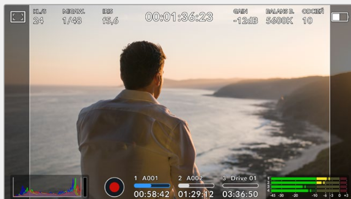
Ekran dotykowy LCD z włączonymi liniami kadru o proporcjach 2.40:1
