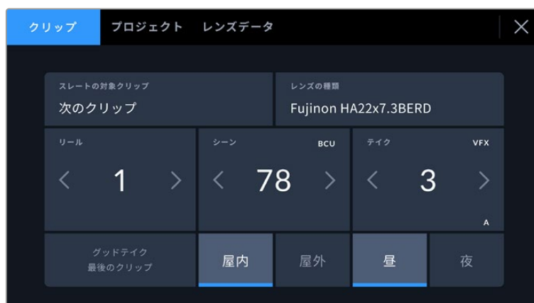
URSA Broadcast G2のスレートは「クリップ (CLIPS)」、「プロジェクト (PROJECT)」、「レンズデータ (LENS DATA)」タブに分かれています。
