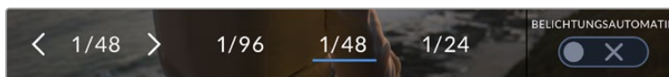
Ihre URSA Broadcast G2 schlägt Ihnen flimmerfreie Verschlusszeiten entsprechend der Netzfrequenz vor, die Sie im SETUP-Menü ausgewählt haben
