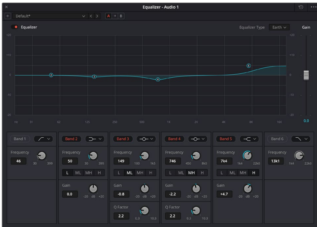
La sezione EQ del mixer indica se la traccia è stata equalizzata
